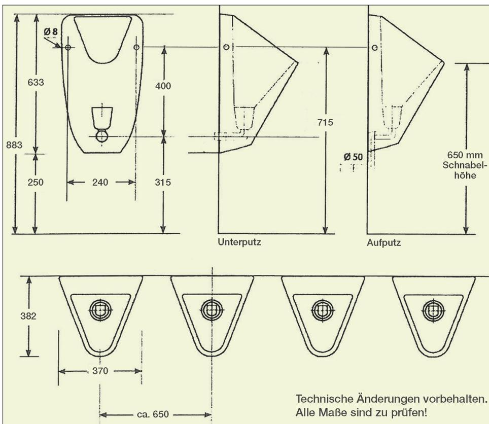
Nach dem Urinal darf **kein Siphon** montiert werden!
