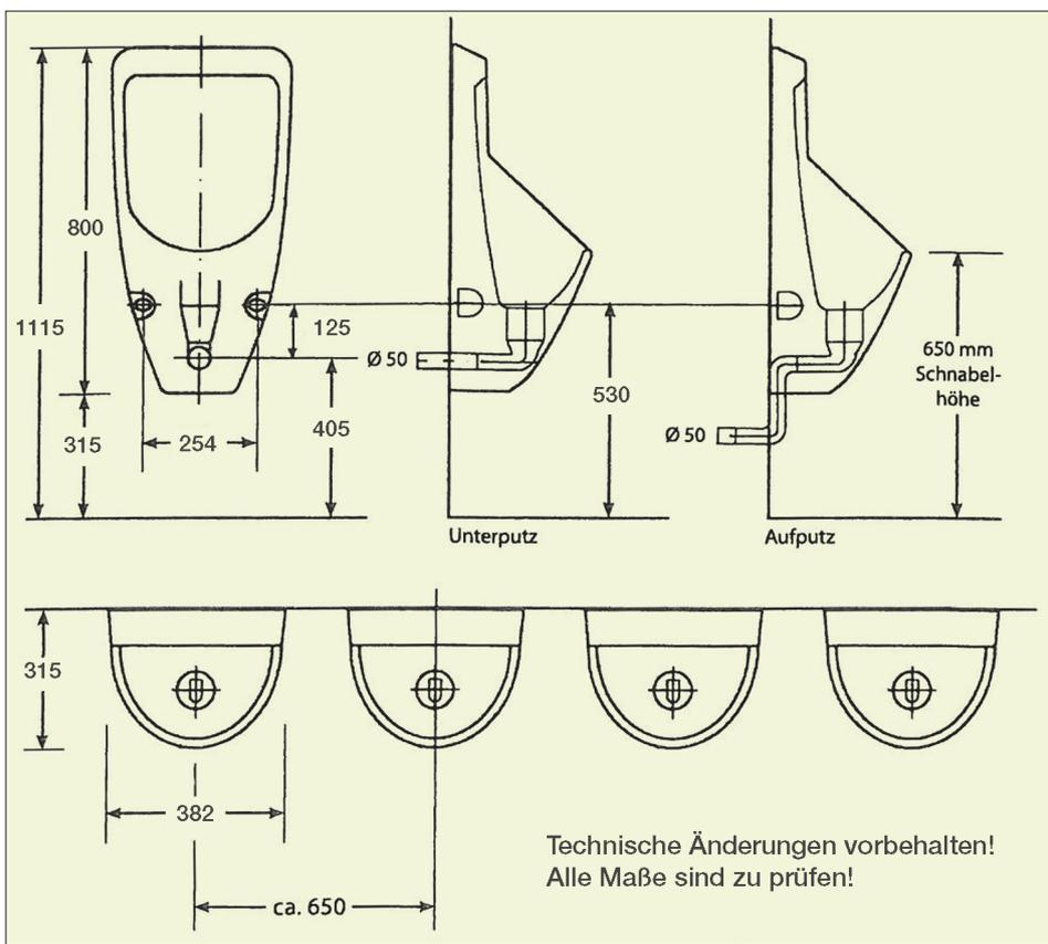
**Nach dem Urinal darf kein Siphon montiert werden!**
