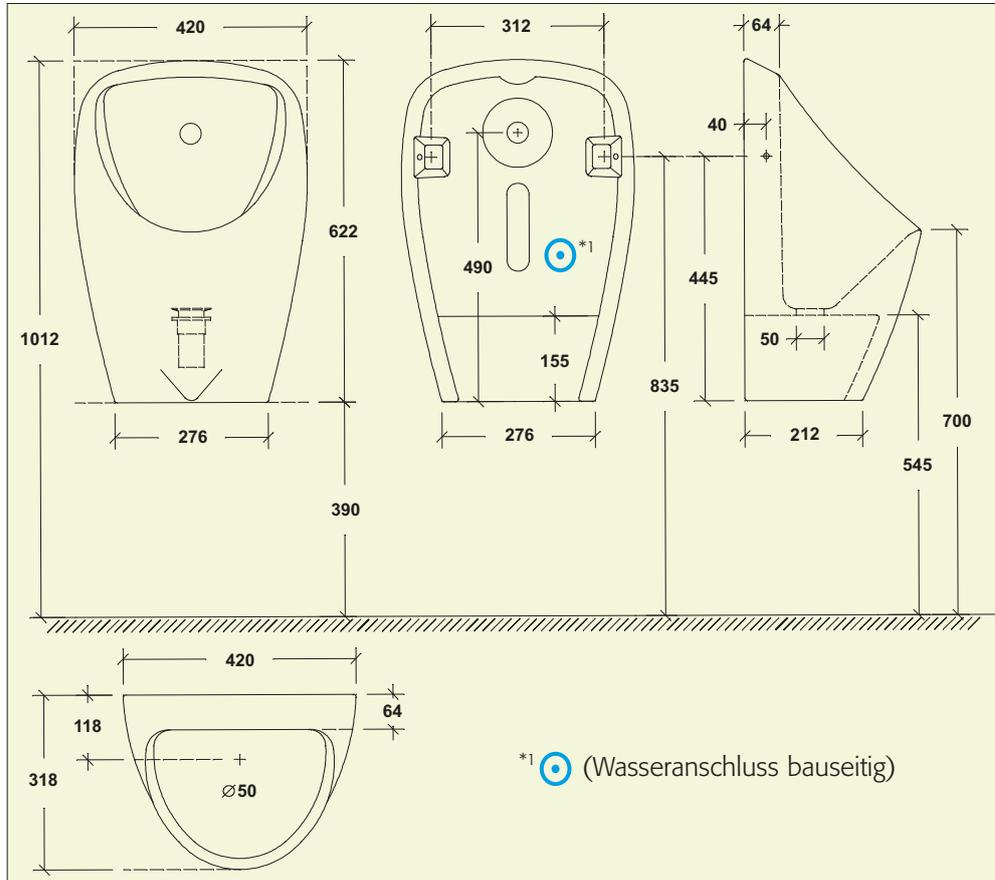
Wasseranschluss muss bauseitig hinter dem Becken zur Verfügung stehen.
